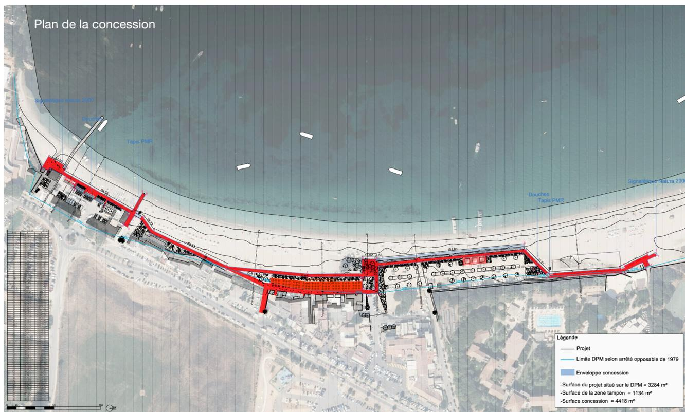
La promenade en bois a une surface approximative de 3 284 m<sup>2</sup>. Une zone tampon de part et d'autre de l'ouvrage est prévue sur une surface approximative de 1 134 m<sup>2</sup> dans le projet de concession. Cette zone permet la réalisation des travaux nécessaires à l'implantation de la promenade.
